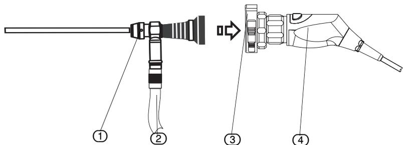
为了安装内窥镜，摄像头须装备一个带紧固门的镜头 ③。必要时请将这个镜头旋到摄像头上（见 5.1 紧固门操作 一章）。
