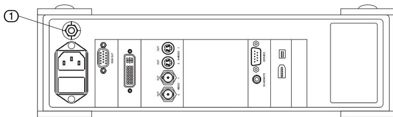
图 4-6 布置 / 接线: 电位均衡
