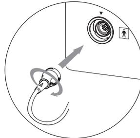
2. 将插头 ③ 插入 CCU 插座 ②, 直至止端。按顺时针方向旋转 90°, 锁住插头。之后啮合槽位于上/下方。
